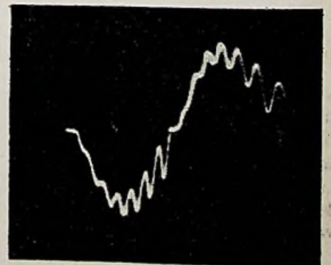
Fig. 5. Oscillogram van de stroomkromme, wanneer een smoorspoel het optreden van kiptrillingen van hooge frequentie belet.
